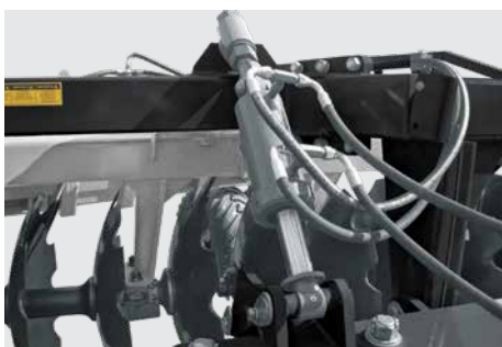
Pistão hidráulico para transporte e nivelamento da grade. Hydraulic Piston for Transportation and leveling of the disc harrow. Pistón hidráulico para el transporte y nivelación de la rastra aradora.
