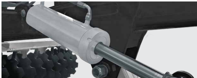
Pistão hidráulico. Hydraulic cylinder for raising. Pistón hidráulico.
